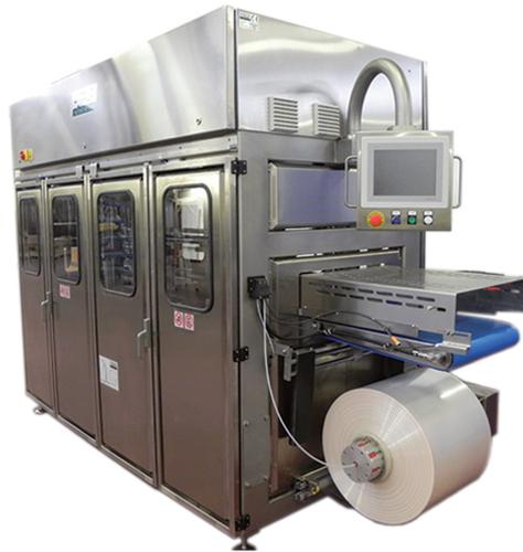
**Imbustatore automatico ultra veloce per salumi e formaggi di grandi dimensioni con creazione delle buste da film tubolare, e scarico su nastro di uscita**
