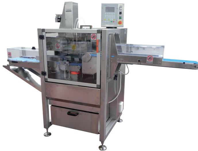
**M**acchina automatica per il "taglio a roccia" di spicchi di formaggio grana da 1kg in pezzature inferiori
